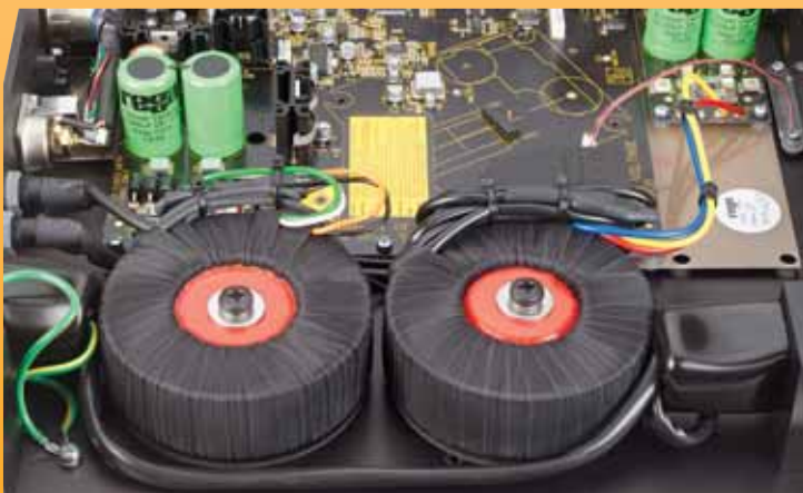
Zwei separate Ringkerntrafos versorgen die digitalen und analogen Kreise des Players
