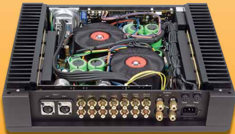
Der Osiris ist mit seinen zwei kräftigen Netzteilen gut gefüllt. Die Leistungselektronik sitzt an den Seiten, der relaisgeschaltete Eingangsbereich unmittelbar bei den Buchsen
