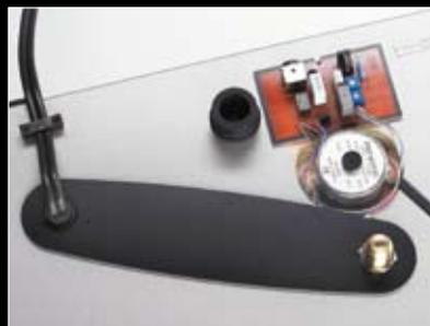
Eine Phenolharz-Brücke versteift auf der Unterseite die Grundplatte.
