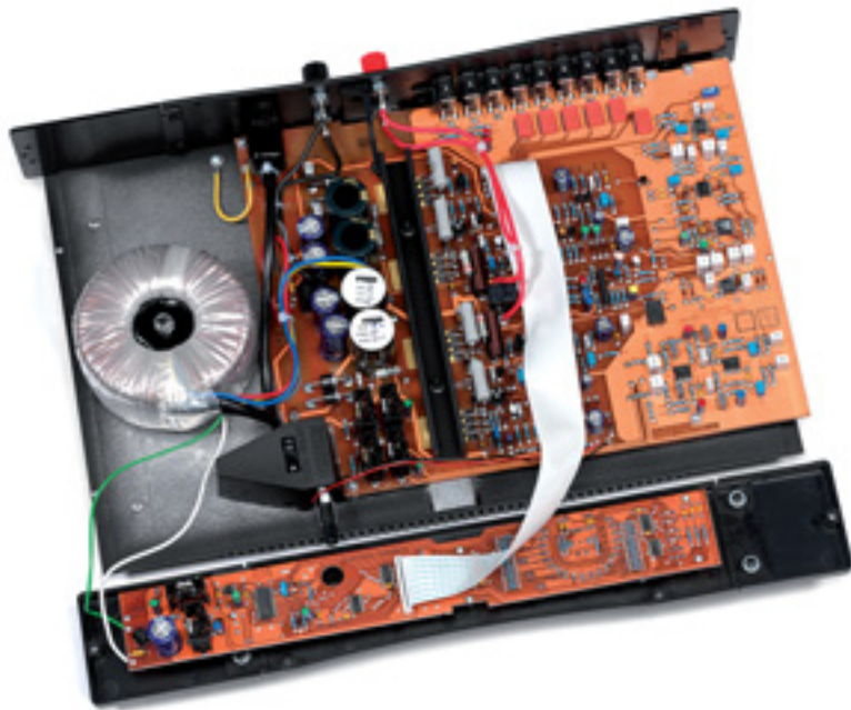
Die Befehlsgewalt hat die schmale Steuerplatine hinter der Front. Von hier aus kontrolliert der „Alpha Encoder“ Lautstärke, Ein- und Ausgangspegel des Mira 3
