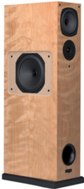
Der Tieftöner in der Nähe des Mittel-/Hochtonteils soll das Phasenverhalten der Drei-Wege-Box optimieren
