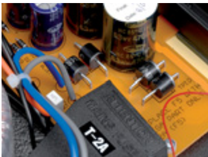
Leistungsfähige Gleichrichter und audiophile Evox-Siebcondensatoren bereiten den Strom für die 85-Watt-Endstufe auf
