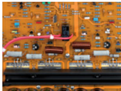
Wie im Vollverstärker unterdrückt auch im Ausgang der Endstufe ein Boucherot-Glied die Schwingneigung der Schaltung
